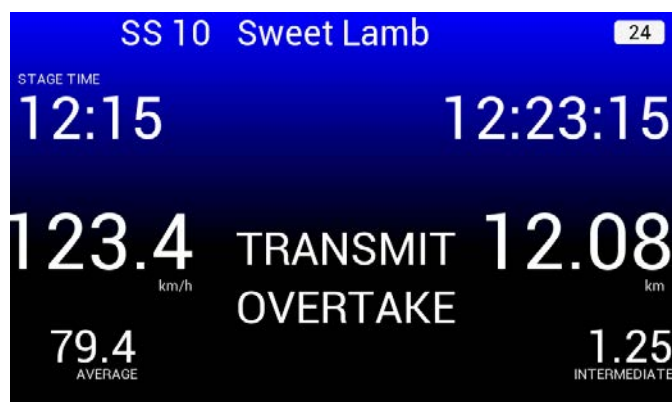
BILD 25: Übertragung Überholanfrage an auflaufendes Fahrzeug - „Transmit Overtake“
