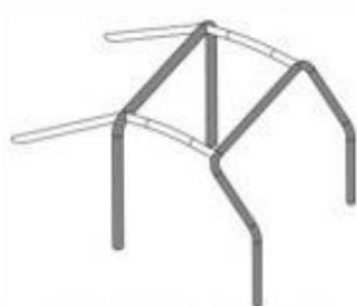
1 főbukócső 1 mellő bukócső 2 hosszanti merevítő 2 hátsó megtámasztás
