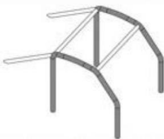
2 oldalsó bukócső 2 keresztmerevítő 2 hátsó megtámasztás
