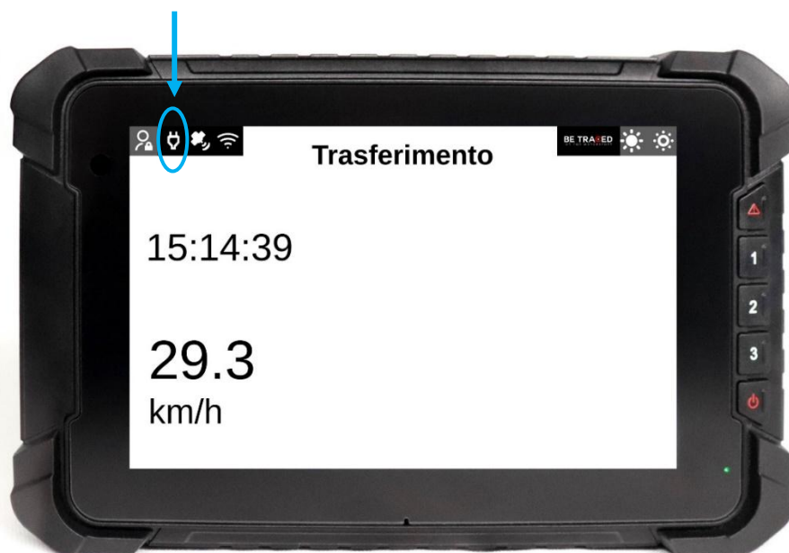
Figura 1 - Spia alimentazione di colore bianco: dispositivo alimentato correttamente
