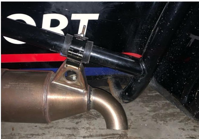
Foto 3: verplicht: meegeleverde bevestiging aan de side protection bar.
