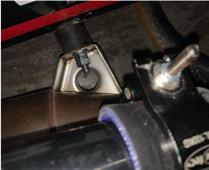
Foto 2: verplicht: bevestiging aan het originele ophangpunt van de uitlaat.
