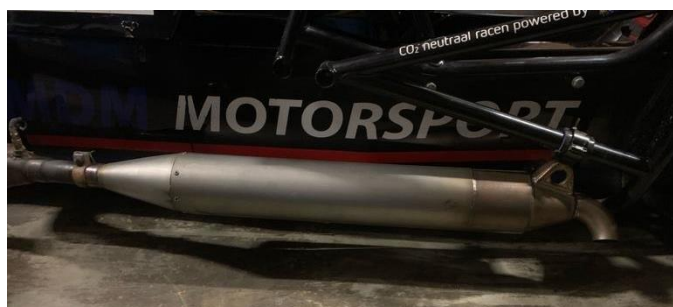
Foto 1: het verplichte uitlaatsysteem, inclusief katalysator,
