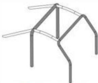
1 főbukócső 1 mellső bukócső 2 hosszanti merevítő 2 hátsó megtámasztás
