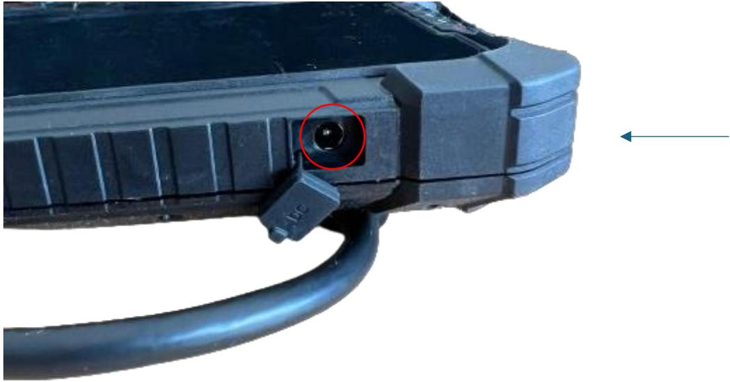
Fig. 4 - Connettore di alimentazione dispositivo BR001
