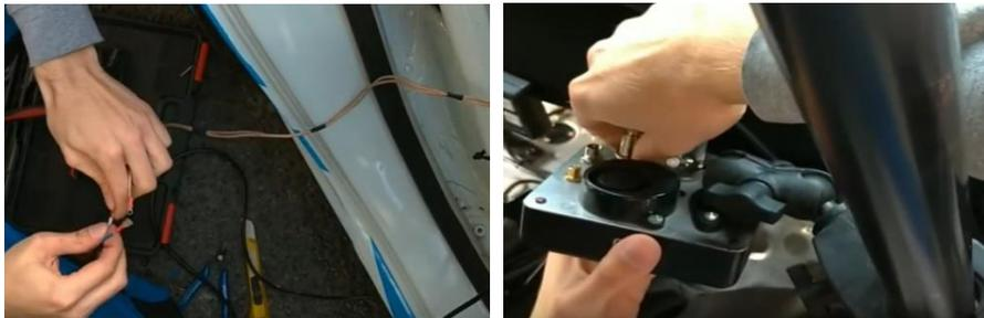
2. Magnetno anteno postavite na streho. Kable napeljite od magnetne antene do okvirja varnostne kletke na strani sovoznika (do točke C - prikazano na sliki na začetku dokumenta) in pustite približno 25 cm rezerve za priključitev teh kablov na GPS enoto na točki A (da kablji niso upognjeni ali deformirani). Kable pritrdite na okvir (vendar ne preveč trdno, zaradi lažje demontaže po reliju).
