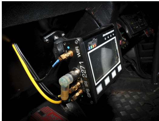
Bild 3: Standardinstallation Gerät+Antenne in klarer / ungehinderter Sicht
