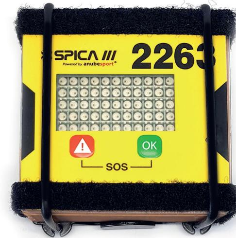
SPICA 3 cuenta con un soporte metálico a medida que debe colocarse con el indicador de la flecha hacia arriba.
