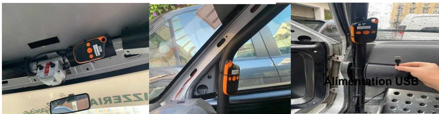
Le boîtier se met en marche à la mise en charge ou avec un appui long de 5 secondes sur le bouton Marche/ Arrêt situé sur le côté droit du boîtier (fig 1) le boîtier vibre et les leds clignotent : il est OK.
