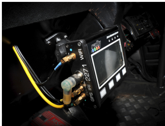
Bild 3: Standardinstallation Gerät+Antenne in klarer / ungehinderter Sicht
