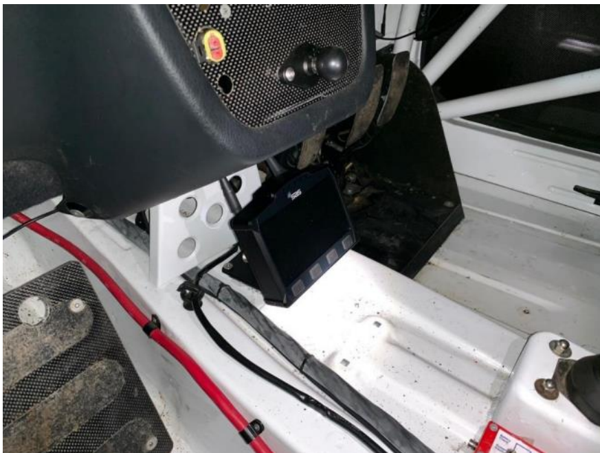
Afbeelding 2. De RallySafe unit gemonteerd op de 25 mm rubberen kogelbevestiging en aangesloten via de RallySafe-connec
