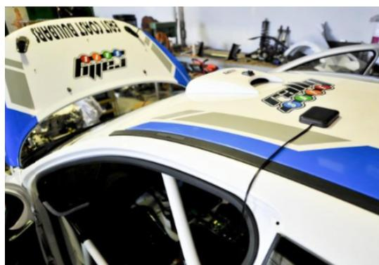
**Bild 13:** geklebte Antenne
