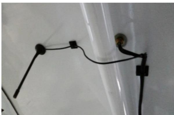
**Bild 14:** Montage WiFi-Antenne Dach-innenseite
