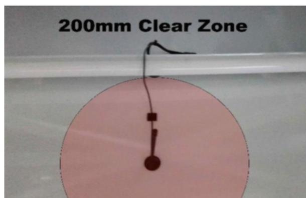
**Bild 15:** „freie Zone“ – Abstand von mind. 200 mm zu allen Komponenten des Überrollkäfigs
