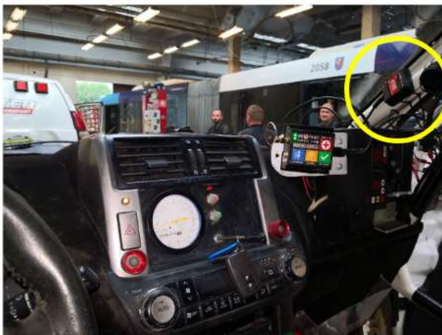
Przykład montażu trackera GPS na słupku „A” klatki bezpieczeństwa za pomocą opasek.
