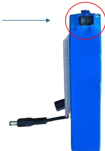
Fig. 2 - Interruttore batteria di emergenza
