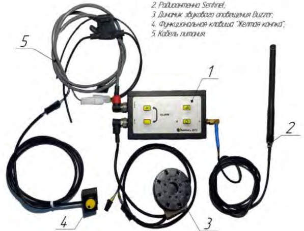
Рис. 5 Комплект системы Sentinel в сборе
