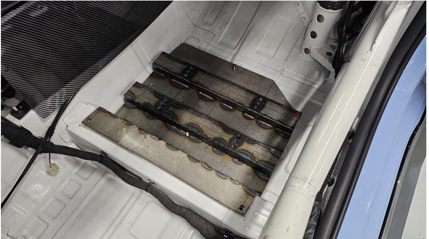
↑ 핸디캡 웨이트 브라켓 설치 위치: 조수석 앞 시트 탈거 위치 바닥
