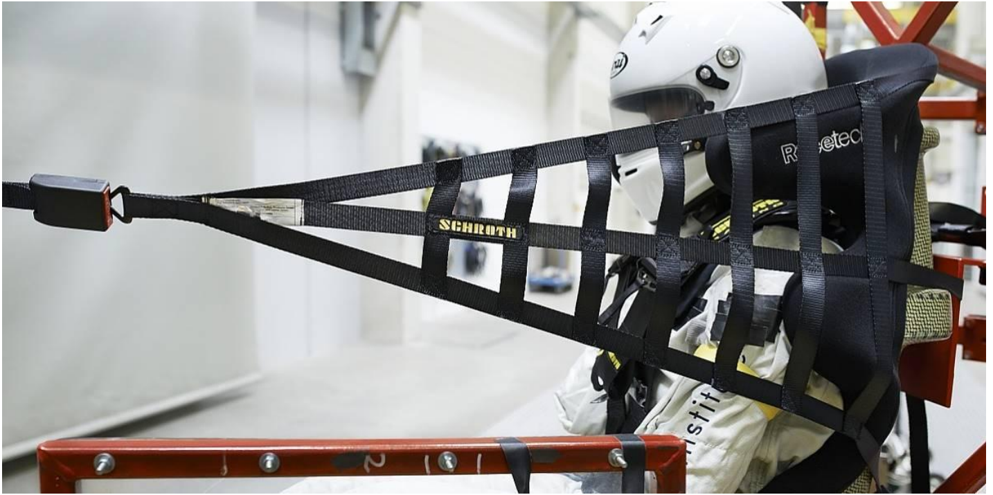
↑ 안전 그물망 설치 예시
